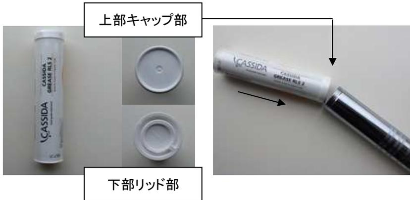
カートリッジグリースの両端のフタを取り外し、上部キャップ部(製品名側 例 CASSIDA GREASE RLS 2 と記載されている側)から油筒に装填してください。
